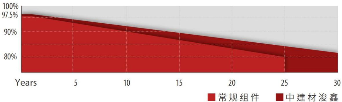
STC 条件如下 : (a) AM 1.5, (b) 辐照度  $1000\text{W}/\text{m}^2$ , (c) 电池片温度  $25^\circ\text{C}$ 。测试根据 IEC 61215 标准, 在接线盒引出端进行测试, 并对照浚鑫太阳能的校准和测试标准 (此标准在组件生产时是有效的)。
